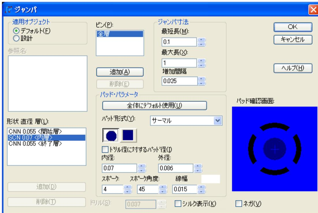
Figure 1-161. [ジャンパ] ダイアログボックス—アンチパッド
