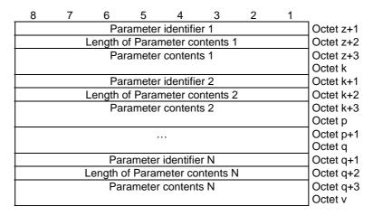
Figure 10.5.144c/3GPP TS 24.008: Parameters list
