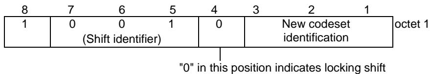
**Figure 10.5.85/3GPP TS 24.008 Locking shift element****Table 10.5.98/3GPP TS 24.008: Locking shift element**
