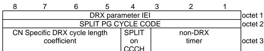
**Figure 10.5.122/3GPP TS 24.008: DRX parameter information element**
