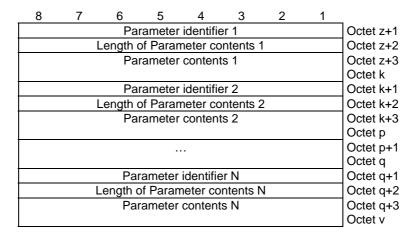
Figure 10.5.144c/3GPP TS 24.008: Parameters list
