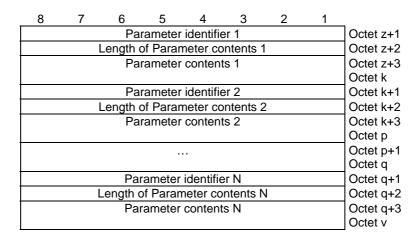
Figure 10.5.144c/3GPP TS 24.008: Parameters list
