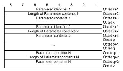
Figure 10.5.144c/3GPP TS 24.008: Parameters list
