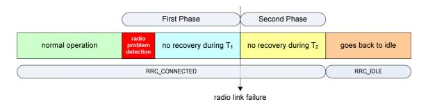
Figure 10.1.6-1: Radio Link Failure
