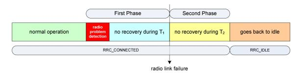
Figure 10.1.6-1: Radio Link Failure
