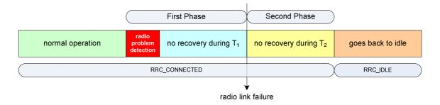
Figure 10.1.6-1: Radio Link Failure
